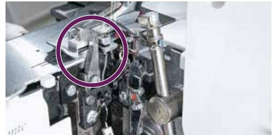
3. Hebe nun den Nähfuß vorne vorsichtig an oder hebe ihn mit dem Kniehebel, wenn deine Maschine über einen verfügt.
