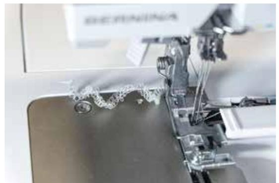
2. Bringe das Messer in die höchste Position, indem du das Handrad zu dir drehst.
