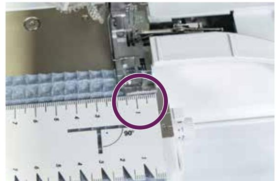
Wenn du dir zu Beginn noch unsicher bist, kannst du die Nahtlinie auch mit Schneiderkreide oder einem anderen Markierwerkzeug einzeichnen und sie dann exakt entlang der Markierung für die linke Nadel auf dem Nähfuß führen. Eine weitere Möglichkeit ist, die Nahtlinie zuvor von Hand oder mit der Nähmaschine zu heften.
