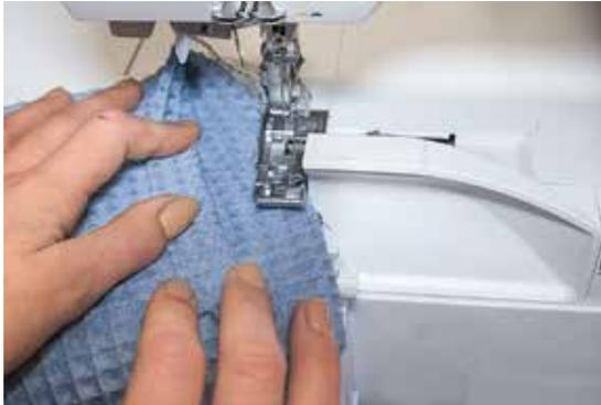
4. Positioniere den Stoff schräg unter dem Messer. Senke den Nähfuß und beginne zu nähen. Drehe dabei den Stoff möglichst schnell in eine gerade Position, sodass du wie bei einer geraden Strecke nähst. Nähe bis zum Beginn des Nahtanfangs.
