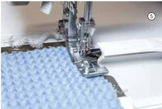
3. Hebe nun den Nähfuß vorne vorsichtig an oder hebe ihn mit dem Kniehebel, wenn deine Maschine über einen verfügt.
